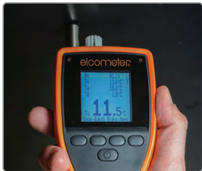
A prueba de polvo e impermeable con sensores completamente sellados (equivalente a IP66)
