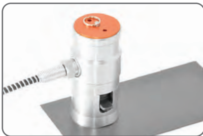
Clip de seguridad del arnés evita el daño accidental de las áreas circundantes durante la prueba en superficies verticales
