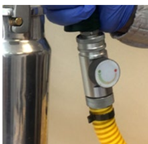
Régulateur de produit par roulette avec indicateur de débit
